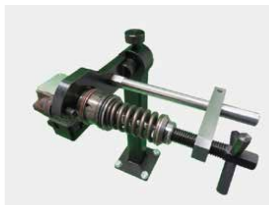
Установка в струбцине насосной секции DAF Bosch 0414755005
