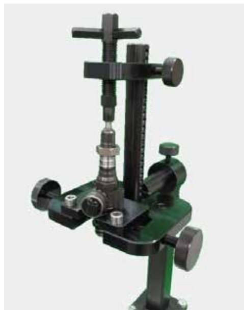
Установка в струбине насос-форсунки SCANIA Ч-образной
